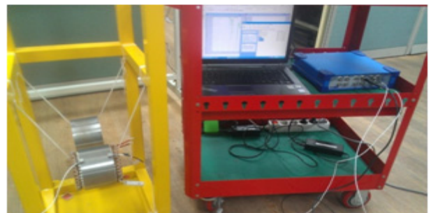
〈그림 3〉 모드 시험 실험 구성
