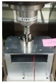
(D) Torque meter and LATM
